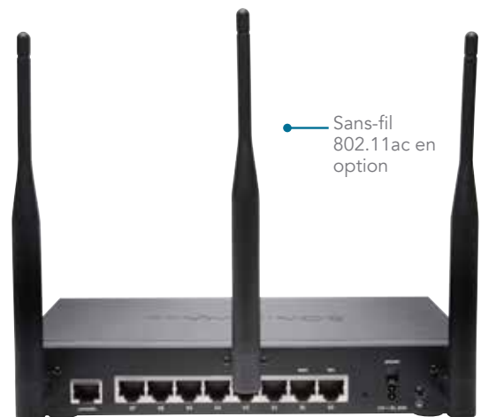
Port de console Commutateur 6 x 1 GbE (configurable) Port LAN X0 Port WAN X1 Alimentation sécurisée Sans-fil 802.11ac en option
