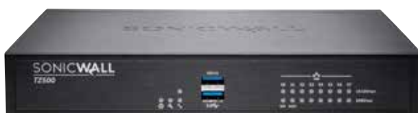
Voyant d'alimentation Voyant de test Port USB (basculement WAN 3G/4G) LED d'indication de liaison et d'activité
