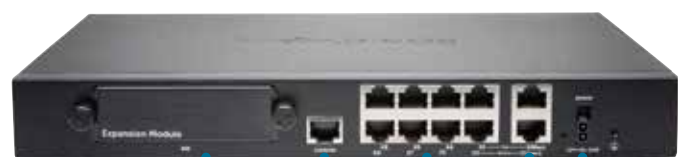
Module d'extension Port de console Commutateur 8 x 1 GbE (configurable) Port LAN X0 Port WAN X1 Alimentation sécurisée
