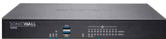
Voyant d'alimentation Voyant de test Port USB (basculement WAN 3G/4G) LED d'indication de liaison et d'activité
